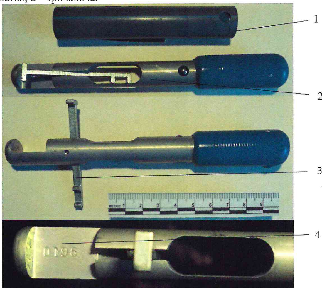
Фото. 1. Запирающее устройство в штатной упаковке: 1- запирающее устройство; 2 – три ключа.
